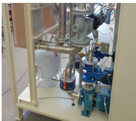
Le unità di termoregolazione, vengono fornite completamente carenate, le connessioni idrauliche sono solitamente posizionate sulla parte superiore, con attacchi filettati o flangiati a seconda della taglia. In questo modo i 4 lati sono completamente accessibili per eventuali manutenzioni, lasciando ampia libertà di installazione ed orientamento nei locali tecnici, anche in spazi ristretti.
